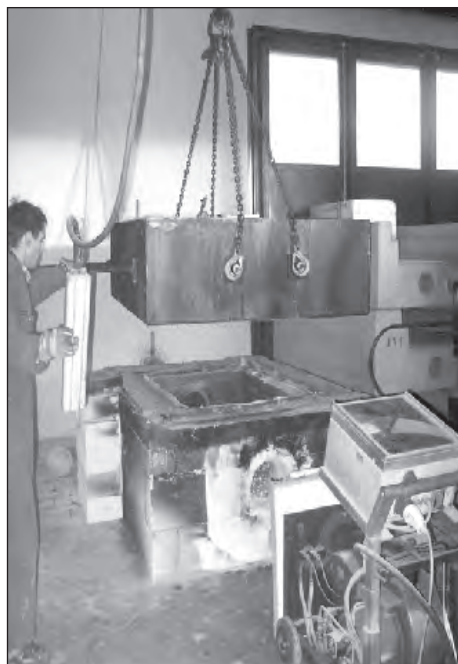
شکل ۱۴. کوره با نمونه مورد آزمایش که درون محل قرار داده می‌شود.
