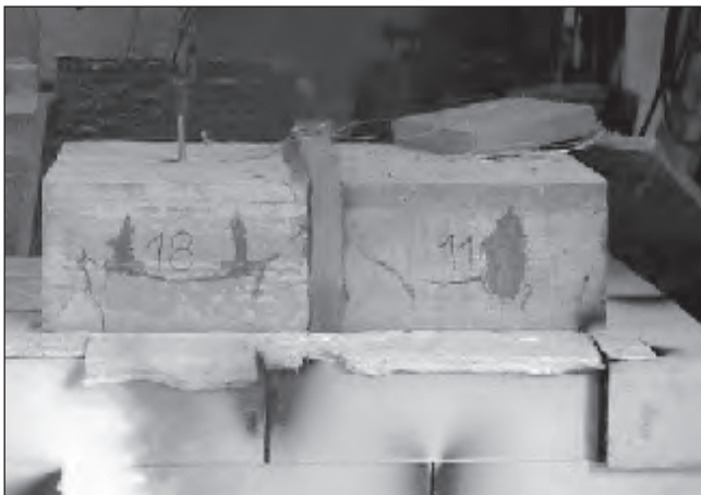
شکل ۱۳. شکل گیری ترک رایج در خلال آزمایشات آتش
