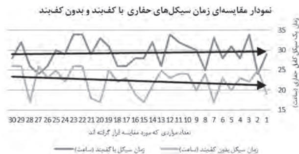
شکل ۱۴ کاهش زمان سیکل حفاری در مقاطع بدون کفبند
