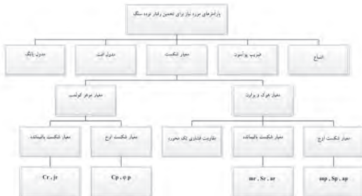
شکل ۵ عوامل مورد نیاز برای تخمین رفتار بعد از مقاومت حداکثر (شکست) توده سنگ (اقتباس از [۷])
