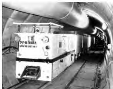
شکل ۲- عکسی از مقطع تونل، داکت تهویه و سیستم حمل و نقل
