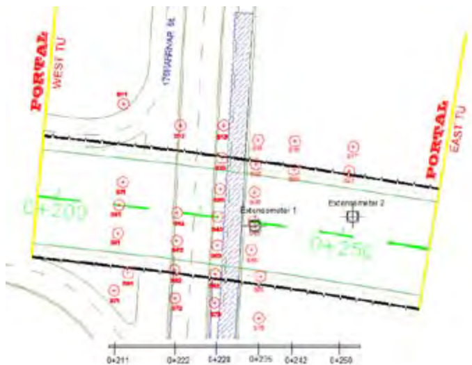
شکل (۳) - آرایش پین های نشست سنج محدوده تونل
