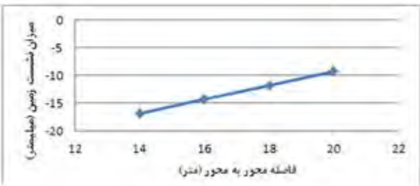
شکل ۵- تأثیر فاصله محور تونل‌ها بر میزان نشست زمین
