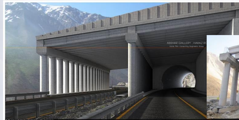
طرح سازه بهمن گیر بر روی مسیر جدید و جاده قدیم
