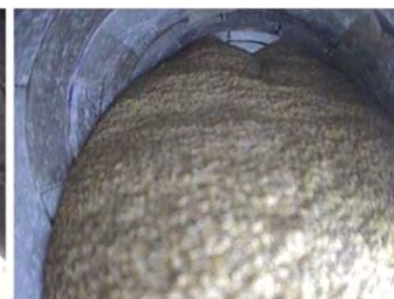
فروریزش خاک به درون تونل مود سوم
