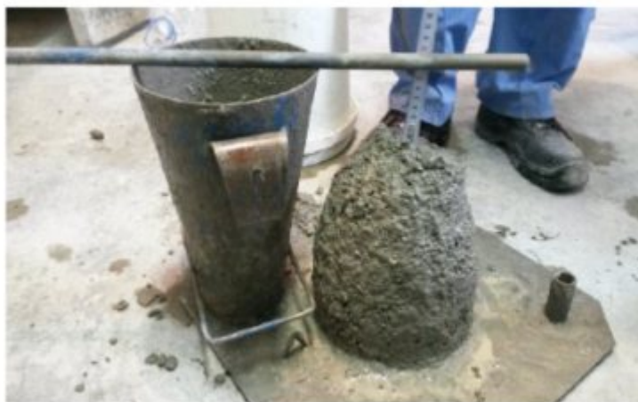
شکل ۲-۳- بتن تازه حاوی الیاف فولادی
