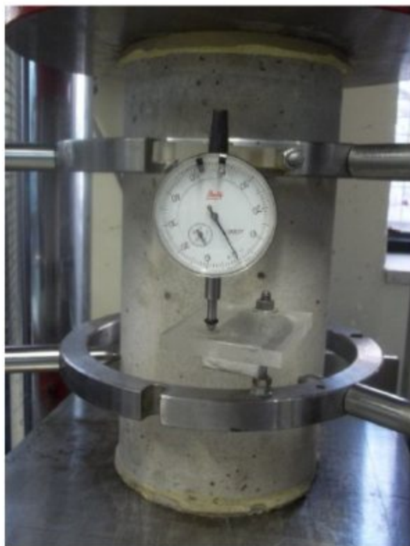
شکل ۳-۶- آزمایش تعیین مدول الاستیسیته
