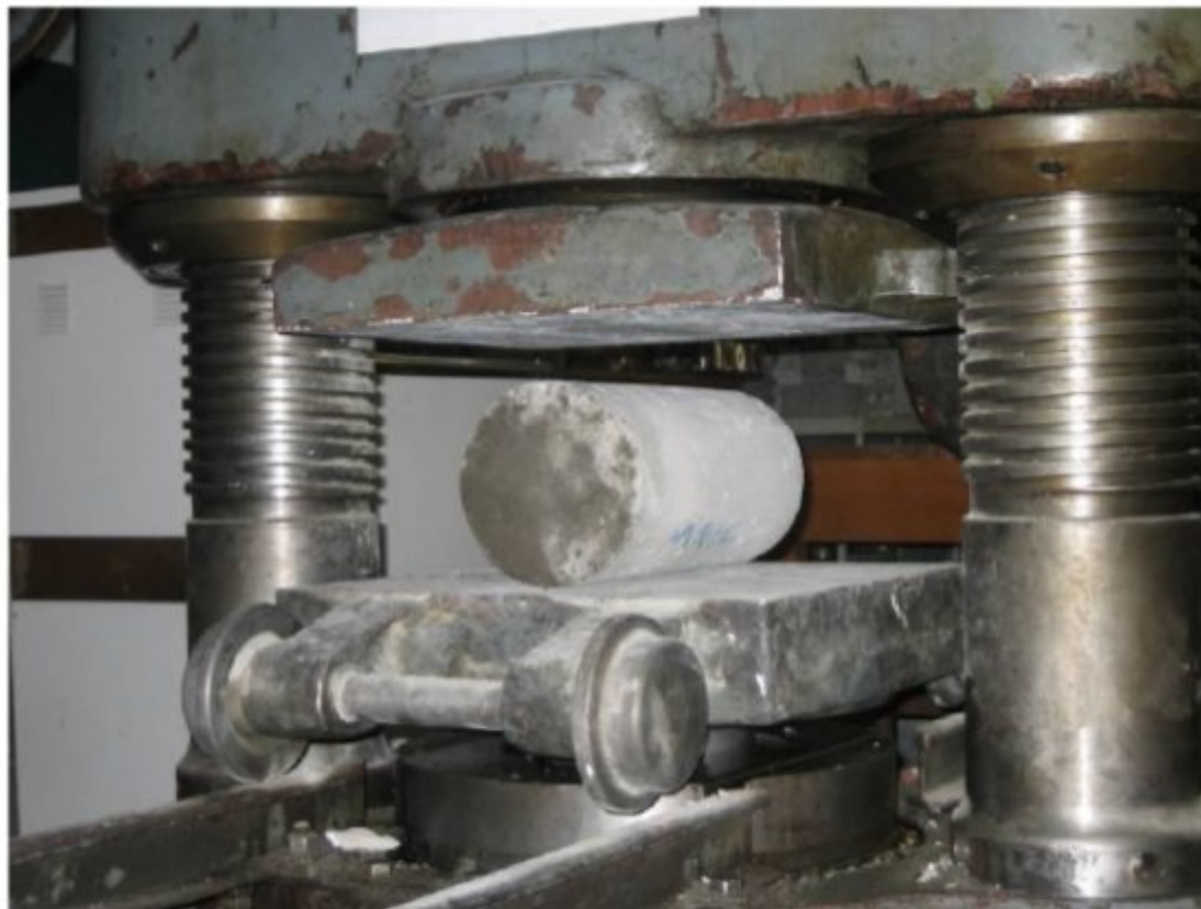
شکل ۳-۲- آزمایش تعیین مقاومت کشش برزیلی
