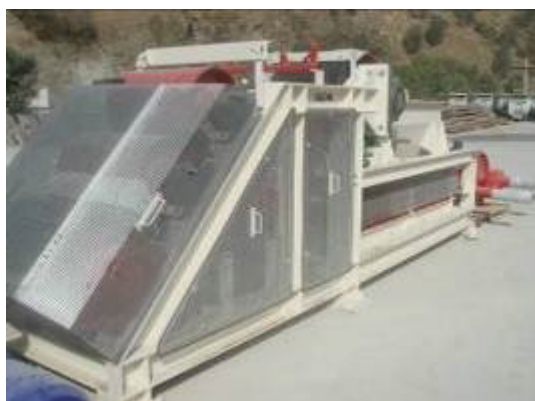
شکل (۶): نمونه‌ای از تقویت‌کننده (بوستر) میانی نوار در پروژه تونل بلند زاگرس
