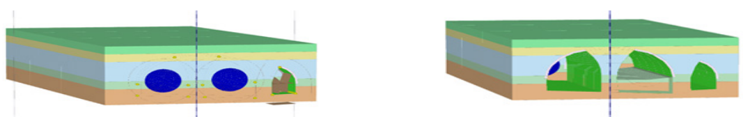
شکل ۶- نمونه ای از مدلسازی مراحل حفاری در نرم افزار PLAXIS3D
