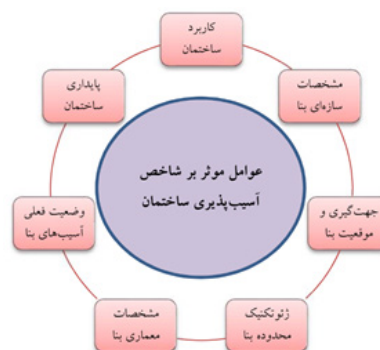
شکل (۱). پارامترهای کلی مورد استفاده در برآورد شاخص آسیب پذیری ساختمان.
