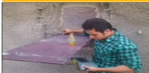
شکل ۶- نمونه‌ای از آزمایش‌های کنترل کیفیت در خط ۶ مترو: (الف) مقاومت کششی PVC و (ب) جوش.
