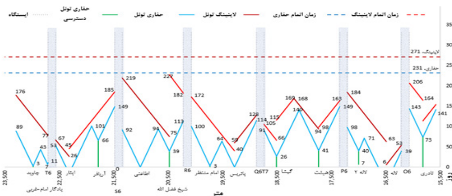
شکل ۴- نمودار LSM قسمتی از مسیر پروژه خط ۶ متروی تهران
