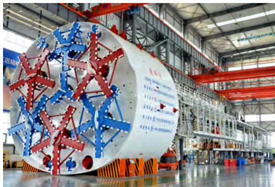
شکل ۴- نمونه‌ای از دستگاه‌های حفاری جهت مقاطع غیر دایره‌ای برای لایه‌های نرم و ریزدانه
